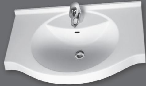
Einzelwaschtisch in einem Stück gegossen, Länge 800 mm, beidseitig geschlossen, mit vorgezogenem ovalem Becken, mit oder ohne Überlauf, mit leicht nach unten abgesetzter Hahnbank, Hahnlochbohrung optional, mit Frontblende 80 mm, mit Wandanschlussprofil 30 mm mit Hohlkehle, Tiefe 450 / 340 mm, mit Rückwand für Stockschraubenbefestigung.
