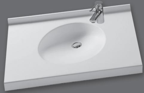
Einzelwaschtisch in einem Stück nach Maß gegossen, Mehrfachwaschtisch aus mehreren Einzelwaschtischen fugenlos miteinander verklebt und fertig konfektioniert, unterfahrbar, mit ovalem Becken, ohne Überlauf, Hahnlochbohrung optional, mit Frontblende 60 mm, mit Wandanschlussprofil 40 mm mit Hohlkehle, Tiefe 500 mm, mit Rückwand für Stockschraubenbefestigung.
