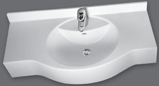
Einzelwaschtisch in einem Stück nach Maß gegossen, Mehrfachwaschtisch aus mehreren Einzelwaschtischen fugenlos miteinander verklebt und fertig konfektioniert, mit vorgezogenem ovalem Becken, mit oder ohne Überlauf, mit leicht nach unten abgesetzter Hahnbank, Hahnlochbohrung optional, mit Frontblende 180 mm, mit Wandanschlussprofil 80 mm mit Hohlkehle, Tiefe 450 / 340 mm, Handtuchhalterausschnitt optional.
