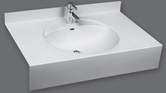
Einzelwaschtisch in einem Stück nach Maß gegossen, Mehrfachwaschtisch aus mehreren Einzelwaschtischen fugenlos miteinander verklebt und fertig konfektioniert, mit rundem Becken, mit oder ohne Überlauf, mit leicht nach unten abgesetzter Hahnbank, Hahnlochbohrung optional, mit Frontblende 180 mm, mit Wandanschlussprofil 80 mm mit Hohlkehle, Tiefe 560 mm, Handtuchhalterausschnitt optional.
