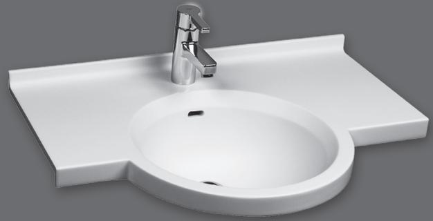
Einzelwaschtisch in einem Stück nach Maß gegossen, Mehrfachwaschtisch aus mehreren Einzelwaschtischen fugenlos miteinander verklebt und fertig konfektioniert, mit vorgezogenem rundem Becken, mit oder ohne Überlauf, Hahnlochbohrung optional, mit Frontblende 40 mm, mit Wandanschlussprofil 30 mm mit Hohlkehle, Tiefe 530 / 340 mm, mit Möbelkante für Anschluss von Verkleidung/Badmöbel.
