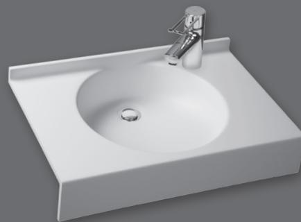
Einzelwaschtisch in einem Stück nach Maß gegossen, Mehrfachwaschtisch aus mehreren Einzelwaschtischen fugenlos miteinander verklebt und fertig konfektioniert, unterfahrbar, mit rundem Becken, ohne Überlauf, Hahnlochbohrung optional, mit Frontblende 100 mm, mit Wandanschlussprofil 30 mm mit Hohlkehle, Tiefe 400 mm, Handtuchhalterausschnitt optional.
