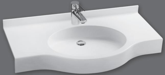
Einzelwaschtisch in einem Stück nach Maß gegossen, Mehrfachwaschtisch aus mehreren Einzelwaschtischen fugenlos miteinander verklebt und fertig konfektioniert, unterfahrbar, mit vorgezogenem ovalem Becken, ohne Überlauf, Hahnlochbohrung optional, mit Frontblende 100 mm, mit Wandanschlussprofil 50 mm mit Hohlkehle, Tiefe 500 / 380 mm, Handtuchhalterausschnitt optional.
