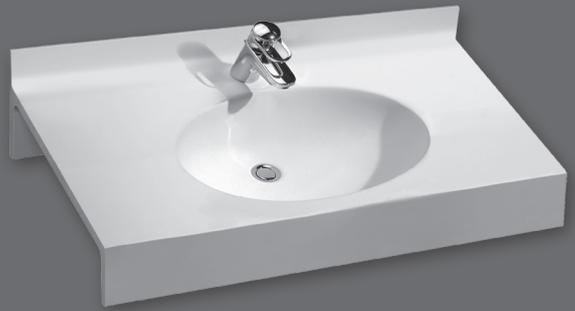
Einzelwaschtisch in einem Stück nach Maß gegossen, Mehrfachwaschtisch aus mehreren Einzelwaschtischen fugenlos miteinander verklebt und fertig konfektioniert, mit ovalem Becken, mit oder ohne Überlauf, Hahnlochbohrung optional, mit Frontblende 200 mm, mit Wandanschlussprofil 80 mm mit Hohlkehle, Tiefe 550 mm, Handtuchhalterausschnitt optional, mit Rückwand für Stockschraubenbefestigung.
