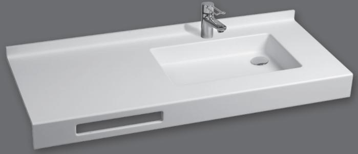
Einzelwaschtisch in einem Stück nach Maß gegossen, Mehrfachwaschtisch aus mehreren Einzelwaschtischen fugenlos miteinander verklebt und fertig konfektioniert, unterfahrbar, als rechte oder linke Version mit seitlich versetzter Ablauföffnung, mit rechteckigem Becken, ohne Überlauf, Hahnlochbohrung optional, mit Frontblende 100 mm, mit Wandanschlussprofil 40 mm mit Hohlkehle, Tiefe 500 mm, Handtuchhalterausschnitt optional.
