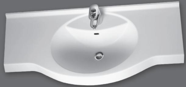
Einzelwaschtisch in einem Stück nach Maß gegossen, Mehrfachwaschtisch aus mehreren Einzelwaschtischen fugenlos miteinander verklebt und fertig konfektioniert, mit vorgezogenem ovalem Becken, mit oder ohne Überlauf, mit leicht nach unten abgesetzter Hahnbank, Hahnlochbohrung optional, mit Frontblende 80 mm, mit Wandanschlussprofil 30 mm mit Hohlkehle, Tiefe 450 / 340 mm.
