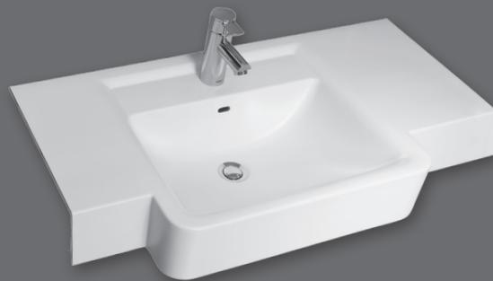
Einzelwaschtisch in einem Stück nach Maß gegossen, Mehrfachwaschtisch aus mehreren Einzelwaschtischen fugenlos miteinander verklebt und fertig konfektioniert, mit vorgezogenem rechteckigem Becken, mit oder ohne Überlauf, mit leicht nach unten abgesetzter Hahnbank, Hahnlochbohrung optional, mit Frontblende 120 mm, Tiefe 480 / 380 mm, Handtuchhalterausschnitt optional.
