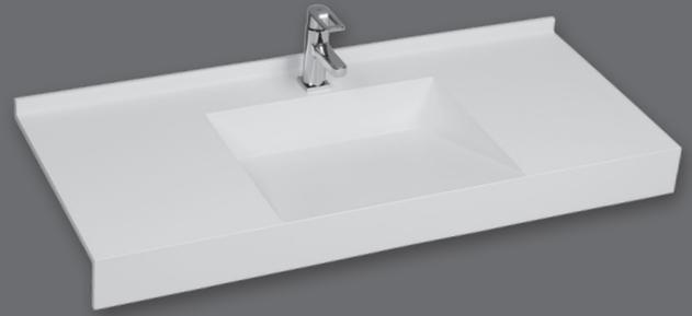
Einzelwaschtisch in einem Stück nach Maß gegossen, Mehrfachwaschtisch aus mehreren Einzelwaschtischen fugenlos miteinander verklebt und fertig konfektioniert, unterfahrbar, mit rechteckigem, schräg zur frei zugänglichen Wasserablaufrinne verlaufendem Becken, mit direktem Übergang in die Ablauföffnung, ohne Überlauf, Hahnlochbohrung optional, mit Frontblende 100 mm, mit Wandanschlussprofil 30 mm mit Hohlkehle, Tiefe 520 mm, Handtuchhalterausschnitt optional.
