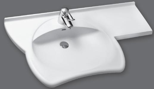
Einzelwaschtisch in einem Stück nach Maß gegossen, Mehrfachwaschtisch aus mehreren Einzelwaschtischen fugenlos miteinander verklebt und fertig konfektioniert, mit ovalem Becken, mit oder ohne Überlauf, mit leicht nach unten abgesetzter Hahnbank, Hahnlochbohrung optional, mit Frontblende 38 mm, mit integrierter Greifreling an der Beckenkante, mit Wandanschlussprofil 30 mm mit Hohlkehle, Tiefe 550 / 270 mm, Grifflöcher optional, mit Rückwand für Stockschraubenbefestigung.
