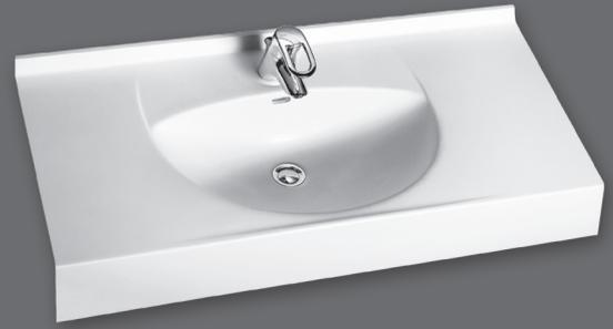
Einzelwaschtisch in einem Stück nach Maß gegossen, Mehrfachwaschtisch aus mehreren Einzelwaschtischen fugenlos miteinander verklebt und fertig konfektioniert, mit U-förmigem Becken, mit oder ohne Überlauf, mit leicht nach unten abgesetzter Hahnbank, Hahnlochbohrung optional, mit Frontblende 160 mm, mit Schwallrand 5 mm an der Vorderkante der Ablagefläche, mit Wandanschlussprofil 40 mm mit Hohlkehle, Tiefe 500 mm, Handtuchhalterausschnitt optional.
