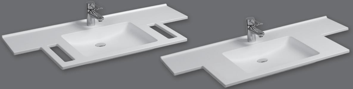
Einzelwaschtisch in einem Stück nach Maß gegossen, Mehrfachwaschtisch aus mehreren Einzelwaschtischen fugenlos miteinander verklebt und fertig konfektioniert, unterfahrbar, Materialstärke im Ablagebereich 20 mm, mit vorgezogenem rechteckigem Becken, ohne Überlauf, Hahnlochbohrung optional, mit Wandanschlussprofil 10 mm mit Hohlkehle, Tiefe 550 / 250 mm, Multifunktionsausschnitt rechts und/oder links optional, mit Rückwand für Stockschraubenbefestigung.
