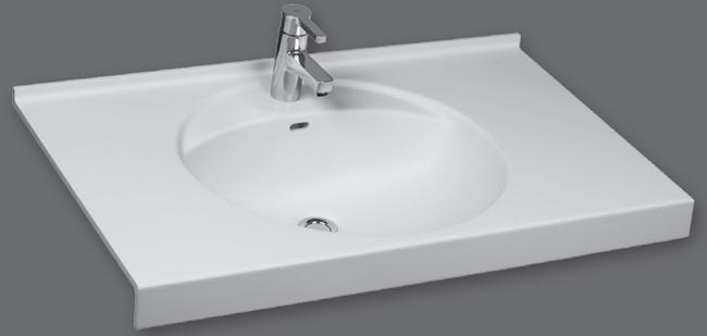
Einzelwaschtisch in einem Stück nach Maß gegossen, Mehrfachwaschtisch aus mehreren Einzelwaschtischen fugenlos miteinander verklebt und fertig konfektioniert, mit rundem Becken, mit oder ohne Überlauf, mit leicht nach unten abgesetzter Hahnbank, Hahnlochbohrung optional, mit Frontblende 70 mm, mit Wandanschlussprofil 20 mm mit Hohlkehle, Tiefe 560 mm.
