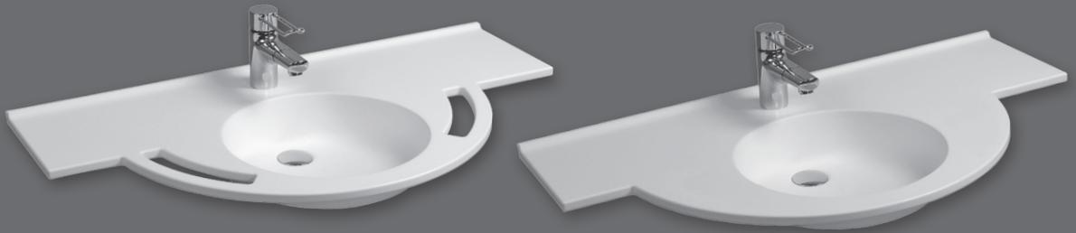
Einzelwaschtisch in einem Stück nach Maß gegossen, Mehrfachwaschtisch aus mehreren Einzelwaschtischen fugenlos miteinander verklebt und fertig konfektioniert, unterfahrbar, Materialstärke im Ablagebereich 20 mm, mit vorgezogenem rundem Becken, ohne Überlauf, Hahnlochbohrung optional, mit Wandanschlussprofil 10 mm mit Hohlkehle, Tiefe 550 / 250 mm, Multifunktionsausschnitt rechts und/oder links optional, mit Rückwand für Stockschraubenbefestigung.
