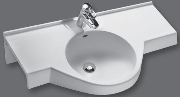
Einzelwaschtisch in einem Stück nach Maß gegossen, Mehrfachwaschtisch aus mehreren Einzelwaschtischen fugenlos miteinander verklebt und fertig konfektioniert, mit vorgezogenem rundem Becken, mit oder ohne Überlauf, Hahnlochbohrung optional, mit Frontblende 60/100 mm, mit Wandanschlussprofil 20 mm mit Hohlkehle, Tiefe 570/340 mm, mit Rückwand für Stockschraubenbefestigung.
