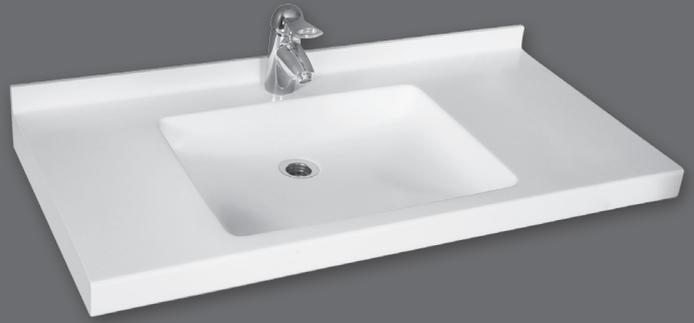
Einzelwaschtisch in einem Stück nach Maß gegossen, Mehrfachwaschtisch aus mehreren Einzelwaschtischen fugenlos miteinander verklebt und fertig konfektioniert, unterfahrbar, mit rechteckigem Becken, ohne Überlauf, Hahnlochbohrung optional, mit Frontblende 50 mm, mit Wandanschlussprofil 40 mm mit Hohlkehle, Tiefe 500 mm, mit Rückwand für Stockschraubenbefestigung.
