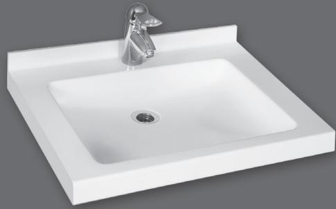
Einzelwaschtisch in einem Stück gegossen, Länge 650 mm, beidseitig geschlossen, unterfahrbar, mit rechteckigem Becken, ohne Überlauf, Hahnlochbohrung optional, mit Frontblende 50 mm, Jerico 550 Integra: mit zusätzlichem Schwallrand 5 mm an der Vorderkante der Ablagefläche, mit Wandanschlussprofil 40 mm mit Hohlkehle, Tiefe Jerico Integra: 500 mm, Tiefe Jerico 550 Integra: 550 mm, mit Rückwand für Stockschraubenbefestigung.
