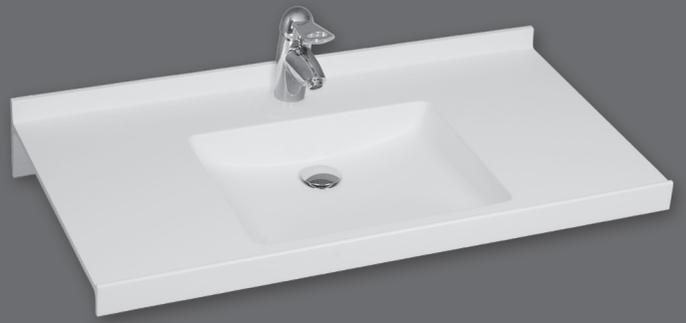
Einzelwaschtisch in einem Stück nach Maß gegossen, Mehrfachwaschtisch aus mehreren Einzelwaschtischen fugenlos miteinander verklebt und fertig konfektioniert, unterfahrbar, mit rechteckigem Becken, ohne Überlauf, Hahnlochbohrung optional, mit Frontblende 50 mm, mit Schwallrand 5 mm an der Vorderkante der Ablagefläche, mit Wandanschlussprofil 40 mm mit Hohlkehle, Tiefe 550 mm, mit Rückwand für Stockschraubenbefestigung.
